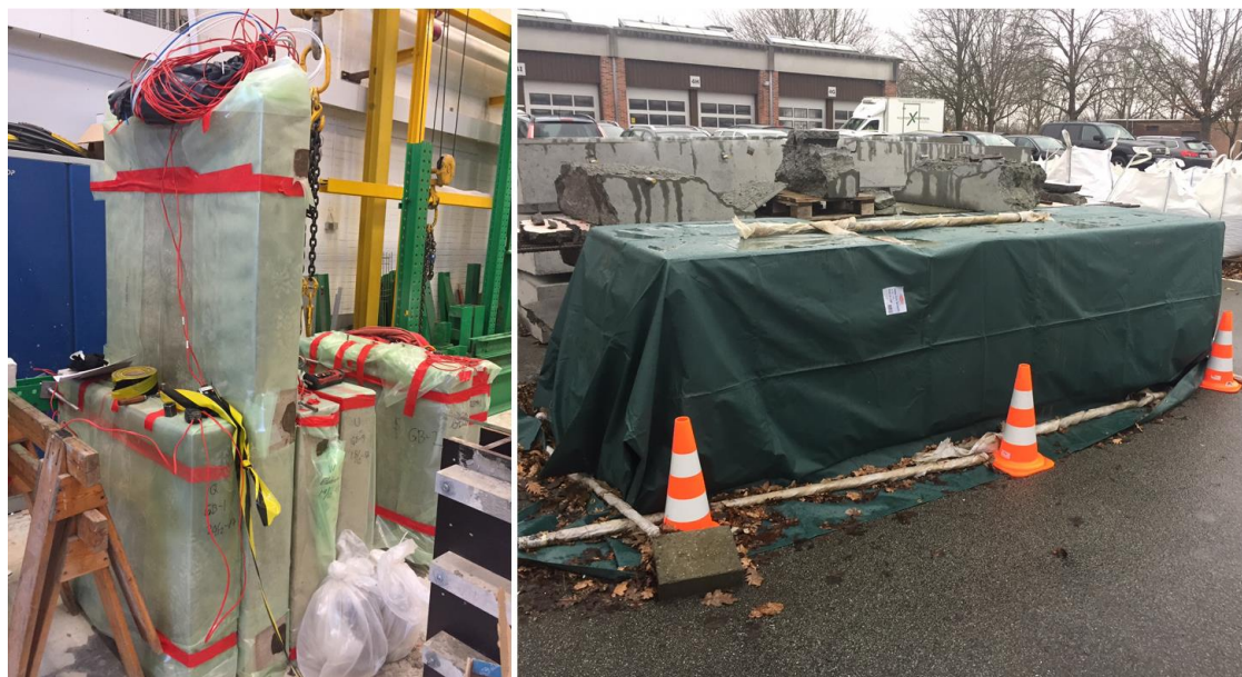
Figur 11. Styring af modenhed. Venstre: Blokke pakket ind og opbevaret i laboratoriet. Højre: Blokke pakket ind og opbevaret udenfor for at forsinke modenhedsudviklingen.
