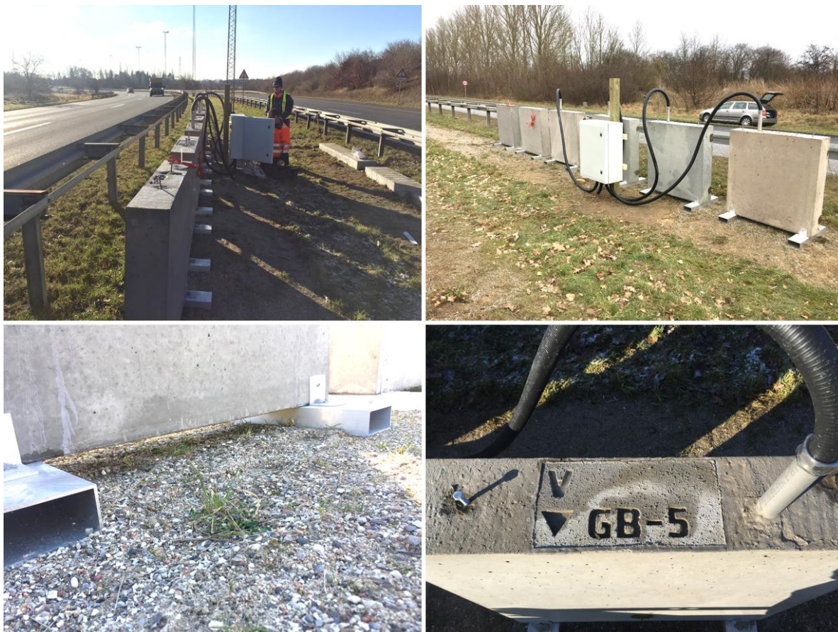
Figur 12. Blokke installeret på Hveens Boulevard i Høje Taastrup. P: Referencen, Q: GB-1, R: GB-3, S: GB-2, T: C+LL, U: GB-9, V: GB-5 og W: X3M. Kabler føres fra de monitorerede blokke til et samleskab med strømforsyning og modem, der løbende sender måledata til Teknologisk Instituts server.
