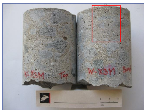
Kernesider. Kernen til højre som er udtaget under vand, er udtaget til analyse. Pastaen fremstår brunlig. Position af slib er markeret.
