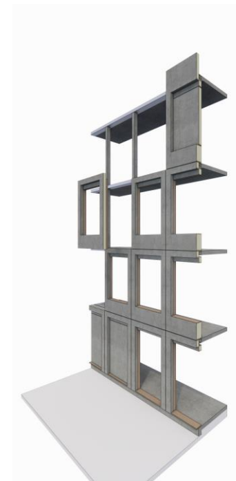
Letfacade som præfab elementer
